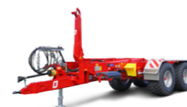
THL 20 (20-24 ton totaalgewicht), 17-21 ton optrekkracht)
