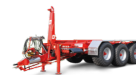
THL 30 (31 - 34 ton totaalgewicht, 30 ton optrekkracht)
